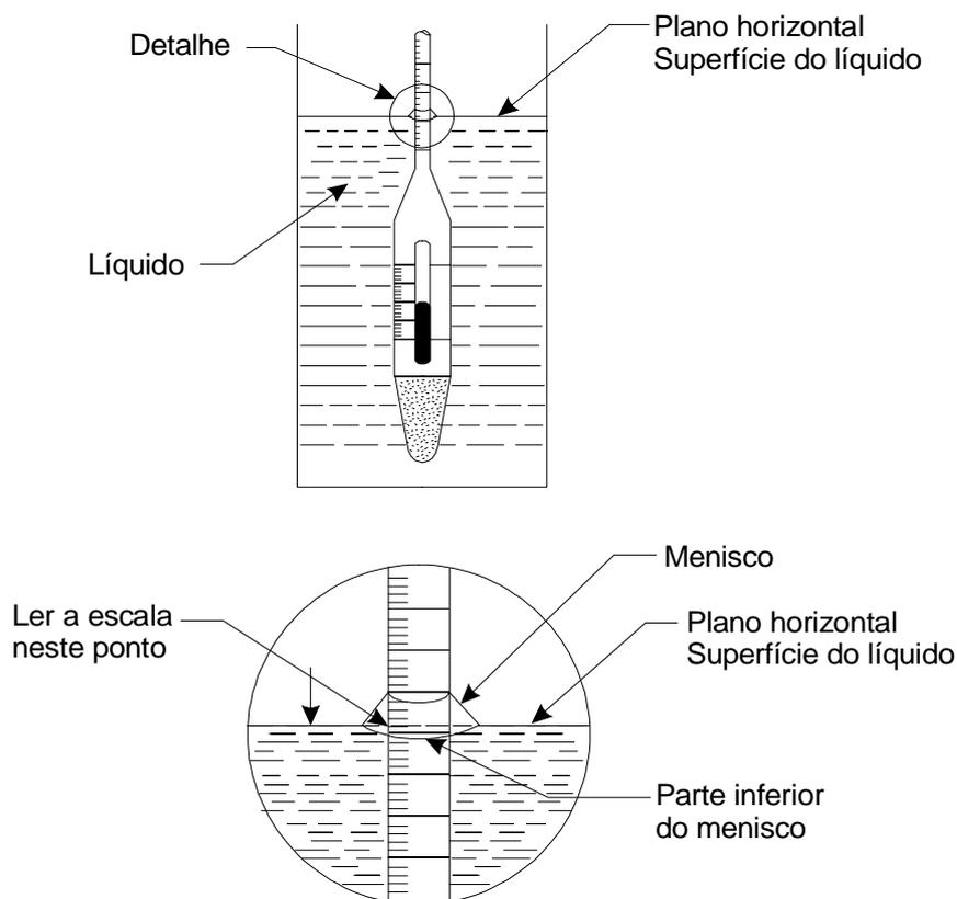
**Figura 1 - Leitura da escala do densímetro para líquidos transparentes**
