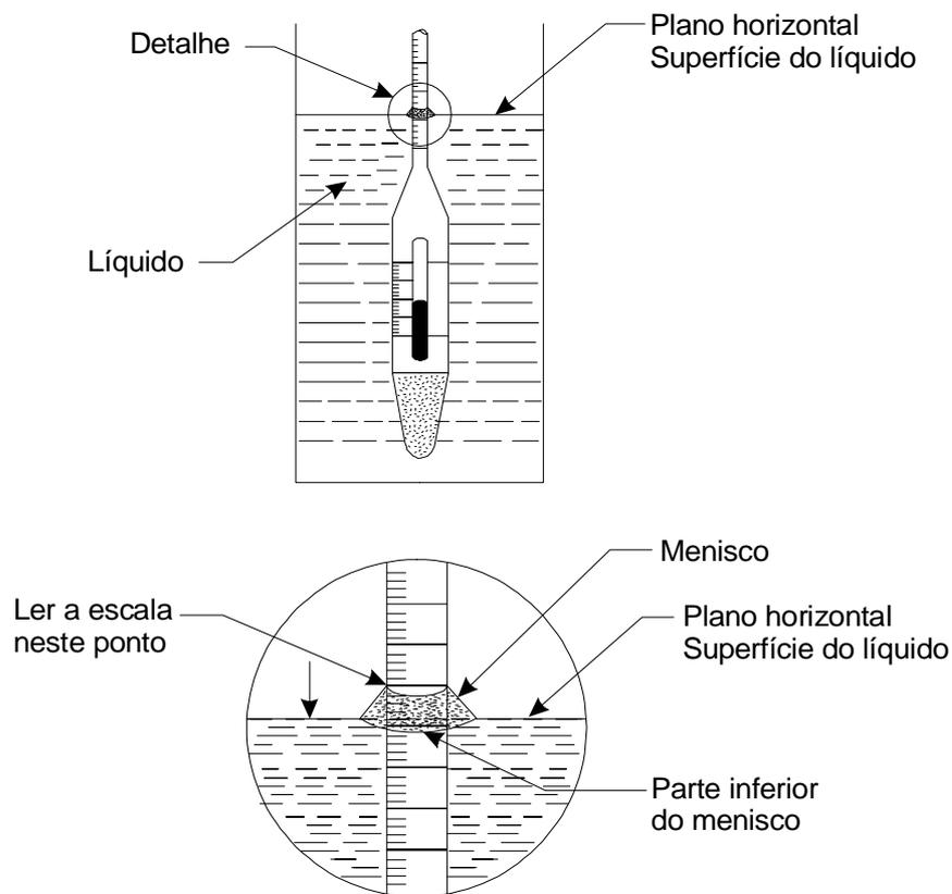
Figura 2 - Leitura da escala do densímetro para líquidos opacos
